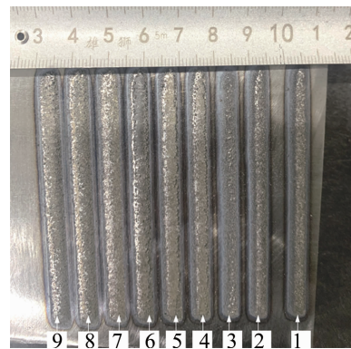
图8 工艺参数对 316L 熔覆层宏观形貌的影响
