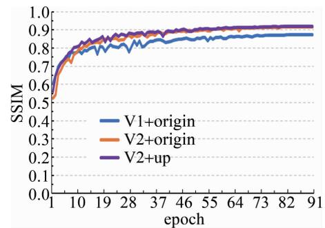
图 9 训练过程中 3 种网络对验证集的结构相似度的变化
