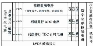
图 3 128 \times 2 阵列读出电路架构 [6]
