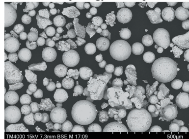
图 1 粉末微观形貌
