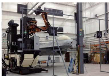
图4 激光清洗 F-16 战机漆层 [26]
