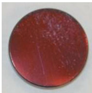
图 1 热等静压离子扩散 Cr:ZnSe 晶体外观图 [16]
