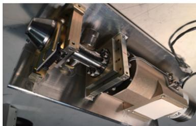
图5  $2 \times 8$  HgCdTe APD 探测器制冷器组件<sup>[15]</sup>
