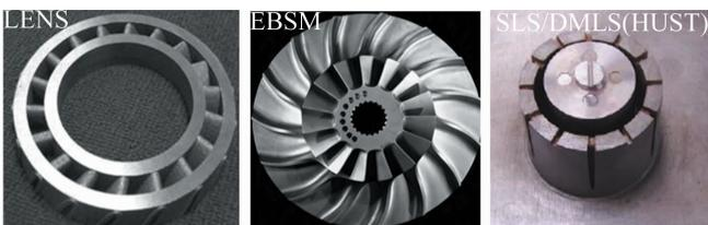
图 4 各打印技术制品<sup>[10]</sup>
