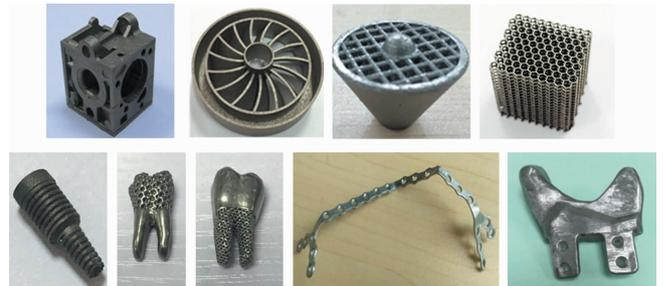
图 5 SLM 复杂结构制造(工业和医疗)
