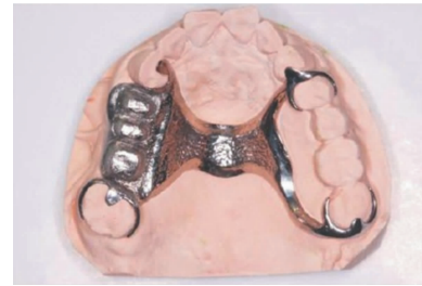
图8 基于SLM成形的可摘除义齿 [89]
