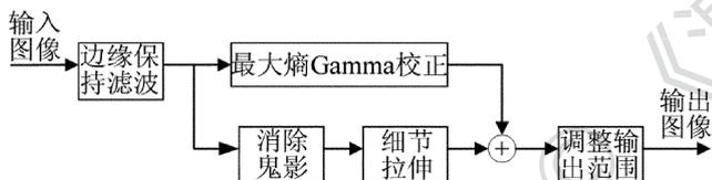
图5 基于局部边界保持滤波器的宽动态图像增强算法流程<sup>[12]</sup>
