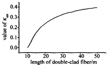
Fig 2 The optimum-pump-position parameter vs length of double-clad fiber 抽运点最佳位置参数和双包层光纤长度的关系曲线; 图 3 是根据 (15) 式仿真得到的优化前后总体抽运损耗功率与双包层光纤长度的关系曲线; 图 4 是通过数值仿真带边界条件 (6) 式的耦合方程组 (1) 式 ~ (5) 式, 再利用 (7) 式得到的优化前后光纤激光器的输出功率与双包层光纤长度的关系曲线。
