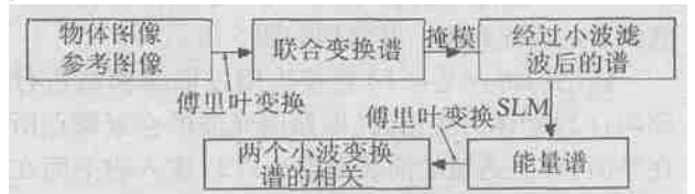
图4 联合变换相关器的实验框图
