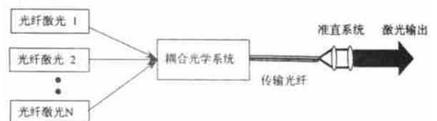
图3 多束光纤激光并联组束示意图
