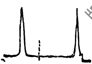
图1 激光波长扫描的示波图形，纵坐标为相对光强度，横坐标为干涉位相对应于激光波长，两峰分别表示m和m+1级的最大干涉，其自由光谱范围为1cm -1
